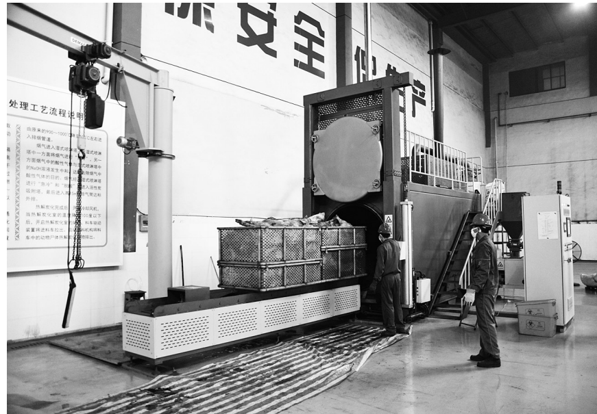
工人用自动传送带将动物尸体送入热解炭化室。 本报记者晏利扬摄
