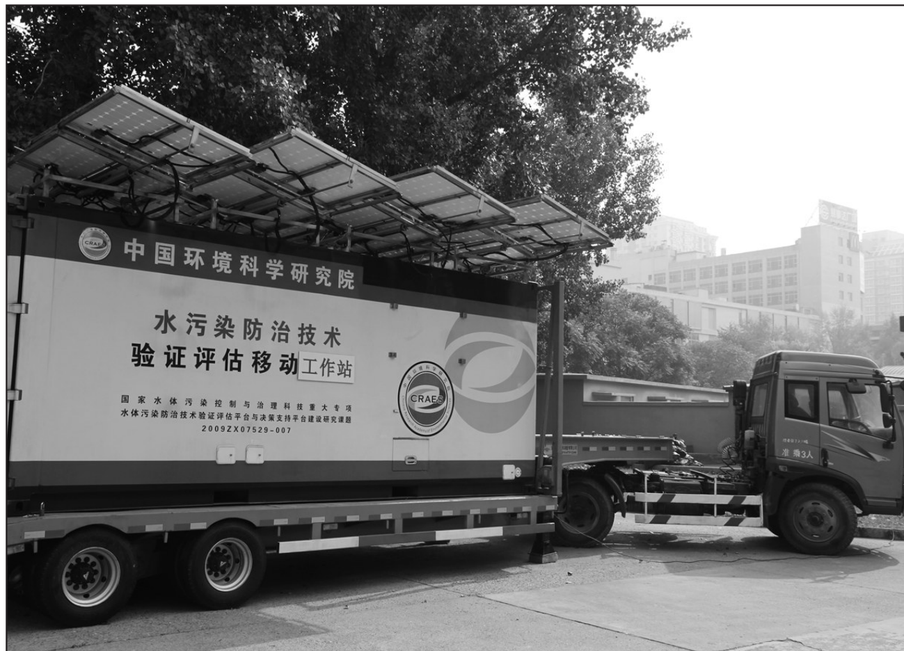
现场验证评估移动工作站可进行多点连续在线测试,可进行工艺运行参数等测试
