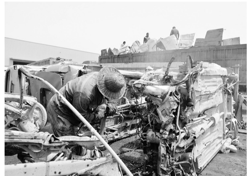
图为国联报废机动车回收拆解有限公司工作人员在拆解废旧机动车。 任效良摄
