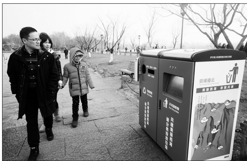
太阳能智能压缩垃圾箱日前亮相杭州西湖,引来游客关注。这种太阳能智能压缩垃圾箱用醒目的字体标明了垃圾分类的标识,引导游客对垃圾分类投放。其内部设有压缩系统,利用箱顶的太阳能电池板产生的电能,可自动对投入的垃圾进行压缩。 人民图片网供图
