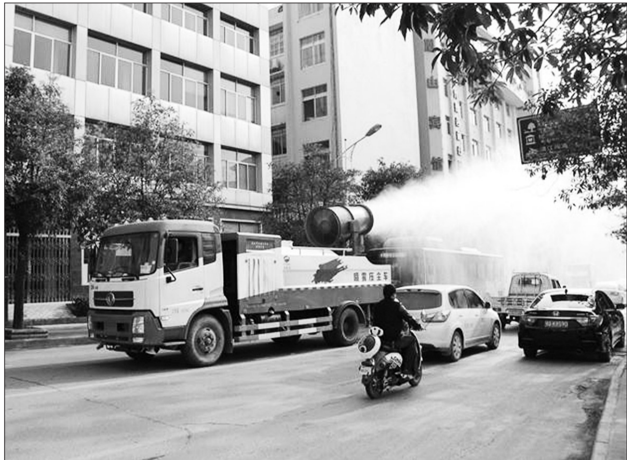
湖北省恩施市日前使用喷雾压尘车作业。这种车主要是利用电机抽水雾化,借风力向外吹洒水雾,让水雾与空气中的尘埃相结合,在重力的作用下沉降,起到降尘并改善环境空气质量的效果。在无自然风力作用下,这种车吹洒距离为50米~80米。 李飞 龙乾摄
