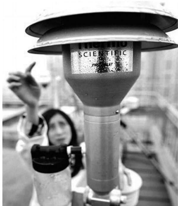
图为环保工作人员正在使用空气质量自动监测仪器
