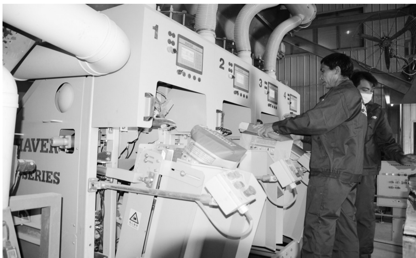
图为上海宇培特种建材有限公司的脱硫石膏砂浆生产线。
