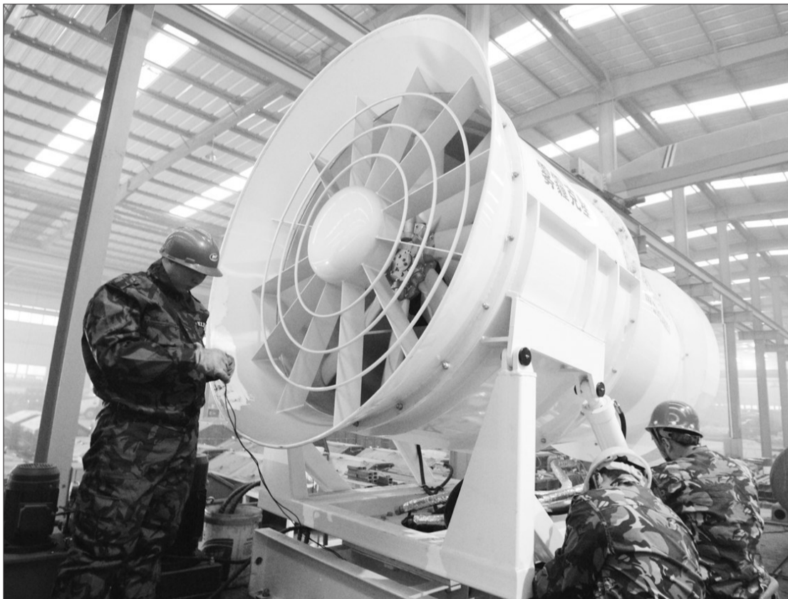
随着雾霾天气的不断来袭,位于河北省邯郸市肥乡县的河北远达车辆制造有限公司近日正在加紧生产“雾炮车”,满足市场需求。据了解,“雾炮车”又叫环保除尘风送式喷雾机,利用风机将水雾喷洒出去,达到抑制扬尘、绿化除尘、净化空气等效果。 人民图片网供图
