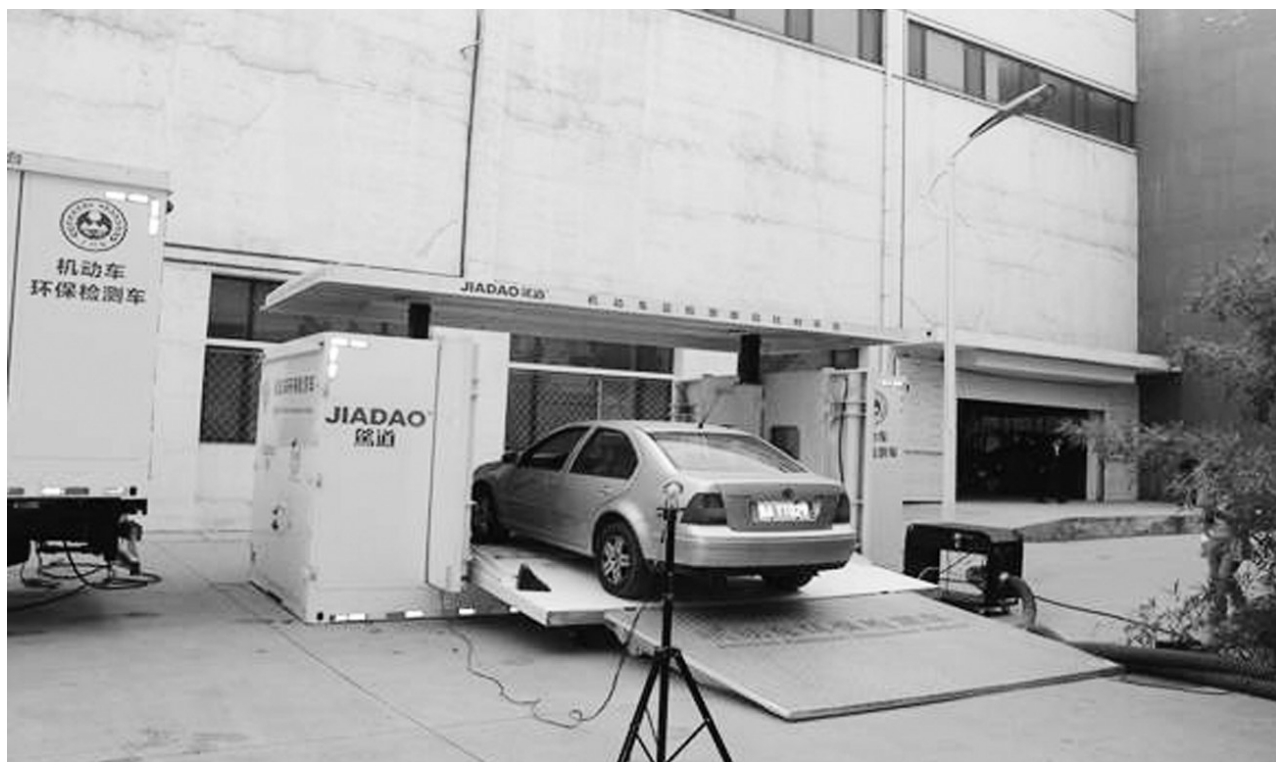
山东省已完成了云检测省级大数据云平台的建设,可实现对1500条环检线的实时数据分析和检测过程监管。图为机动车云检测移动对比平台。 王学鹏摄
