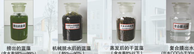
捞出的蓝藻（含水率98%—99%） 机械脱水后的蓝藻（85%—90%） 蒸发后的干蓝藻（含水率8%以下） 复合膜出水（出水COD小于30mg/L）
