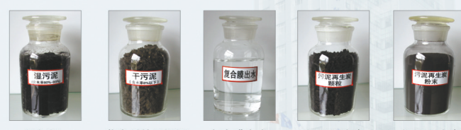
湿污泥（含水率80%—90%） 蒸发后的干污泥（含水率8%以下） 复合膜出水（出水COD小于30mg/L） 污泥再生炭（颗粒） 污泥再生炭（粉末）
