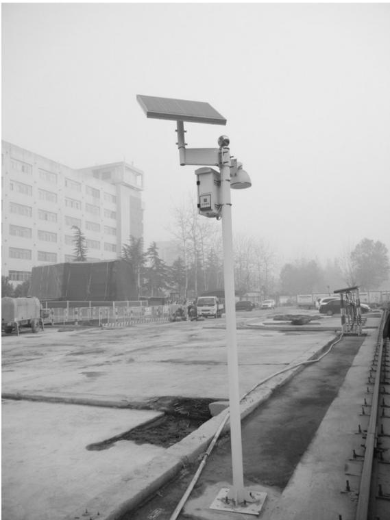
利用高时空分辨率的网格化精准监控系统,可尝试对目前的污染源排放清单进行优化。图为安装在某工地的网格化空气质量微型站,实时监控污染状况。
