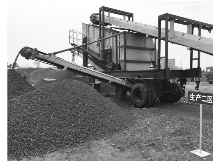
在位于河南省郑州市高新区建筑固废循环利用示范项目现场,建筑垃圾经过这台移动破碎机变成可以替代天然砂石的再生建筑骨料。
