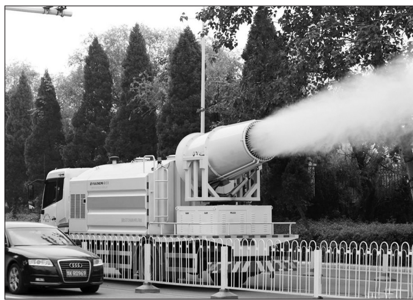
河南省许昌市新购置一台多功能抑尘车并于近日投入使用。这台大型“雾炮”车重达10吨,远距离喷雾系统能喷洒120米远、70米高的水雾,有强大的喷雾降尘作用。经有关部门测试,“雾炮”能够有效降低空气中PM 10 的浓度。中国日报图片网供图
