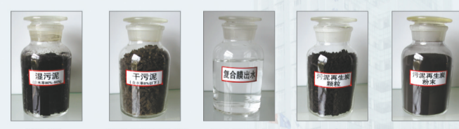
湿污泥 (含水率80%~90%) 蒸发后的干污泥 (含水率8%以下) 复合膜出水 (出水COD<30mg/L) 污泥再生炭 (颗粒) 污泥基炭 (粉末)
