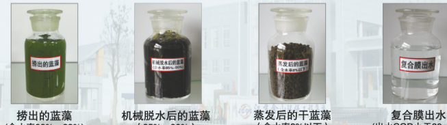
捞出的蓝藻 (含水率98%~99%) 机械脱水后的蓝藻 (85%~90%) 蒸发后的干蓝藻 (含水率8%以下) 复合膜出水 (出水COD<30mg/L)
