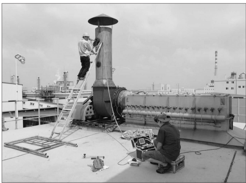
图为环境监测人员正在进行烟气采样监测。
