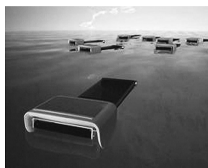
▲美国麻省理工学院研究人员开发出名为“海洋蜂群”的吸油机器人,可以评估海洋油污状况并展开清理工作,还能利用全球定位系统提供的数据,以制定出最有效的清理方案。
