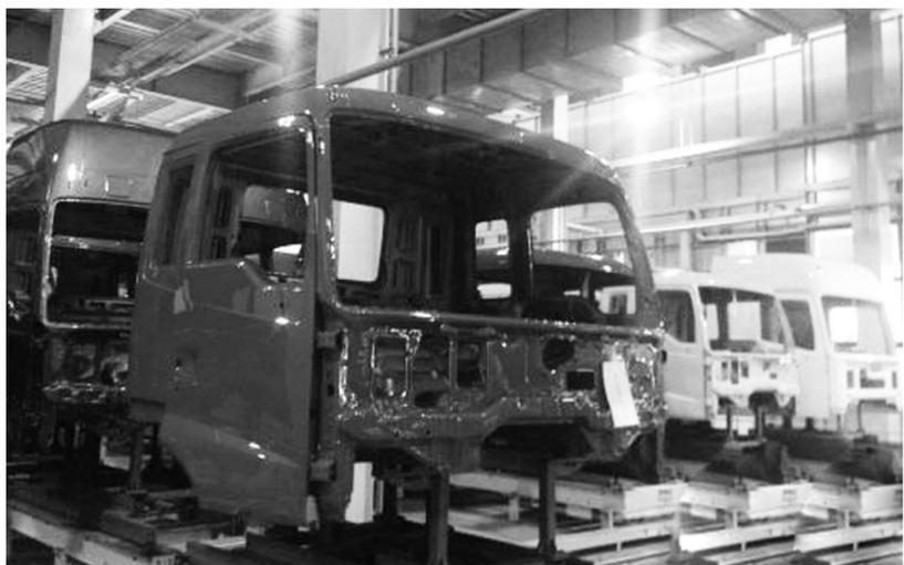
北京市环保局在汽车制造行业,以VOCs减排为重点开展清洁生产审核。图为北京福田戴姆勒汽车公司二工厂涂装车间内,喷涂低VOCs排放水性漆的卡车驾驶室外壳。资料图片
