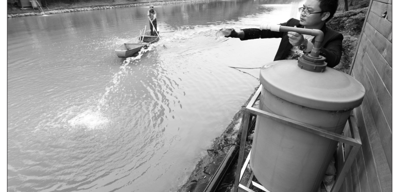
浙江省诸暨市店口镇在中央河道中放置纳米曝气装置,为细菌供氧,增加光照,增强其活跃度,去除污染物,达到净化水质的目的。目前河水水质达到Ⅳ类。 本报记者邓佳摄
