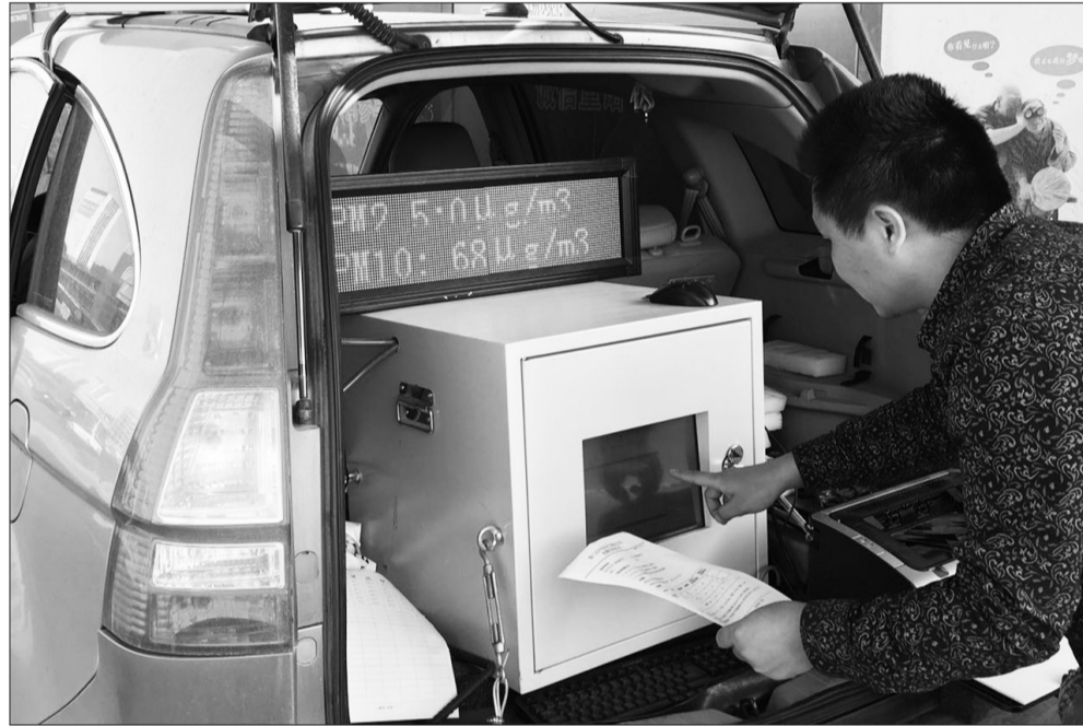
福建省厦门市环保局海沧分局近日购置一套车载粉尘监控系统。这一系统可对建筑工地、道路扬尘等进行现场监测,并现场出监测数据。针对监测结果,环保部门可在第一时间通报相关责任部门,责成责任单位及时整改。沈胜学 雷泽谋摄
