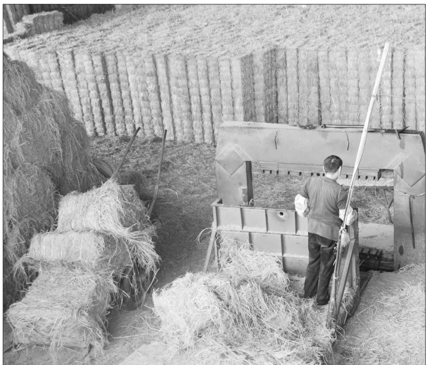
湖北省洪湖市积极探索水稻秸秆综合利用途径,除将秸秆作为生物质发电厂的原料外,洪湖市还兴办了3家草支垫厂,能收储利用稻草20万吨。草支垫能代替枕木,被广泛用于钢铁运输。图为工人在加工草支垫。
