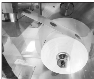
▲图为采用β射线法监测PM 2.5 的自动监测仪,传送带上黑色的原点是通仪器自动采样得到的PM 2.5 。
