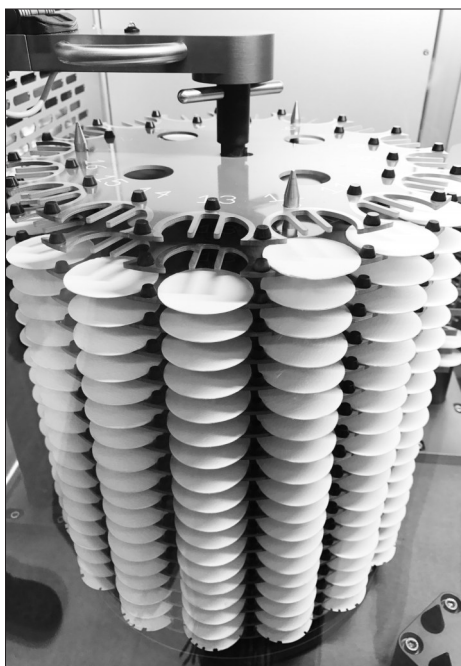
▲称重中心的滤膜称重系统一次可以对320片滤膜进行编码/读码和称重
