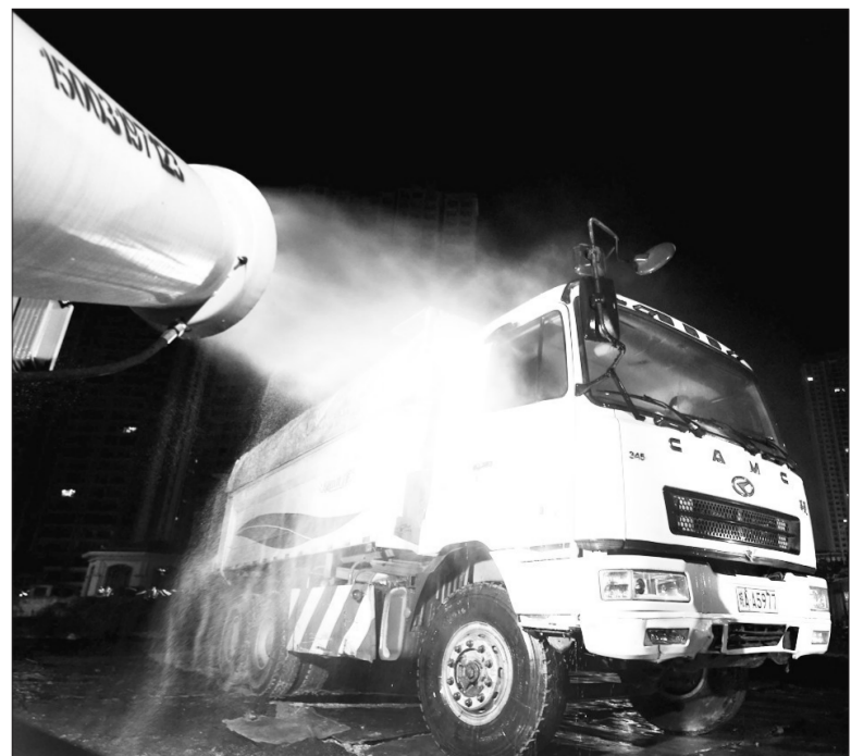
为不断完善辖区建设施工工地的环保除尘措施,安徽省合肥市瑶海区域管理局在全市率先推广使用多功能抑尘设备“环保除尘喷雾炮”,设备的投入使用可以有效抑制工地扬尘,降低空气中的颗粒浓度。 人民图片网供图
