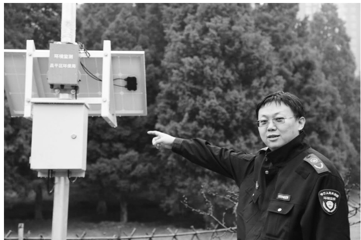
昌平区环保局工作人员手指的盒子就是“微站”的核心部件。设置在昌平公园内的这个实时监控PM 2.5 和PM 10 两个因子的微型监测站,可以实现每一分钟向系统上传一次数据。 本报记者童克难摄
