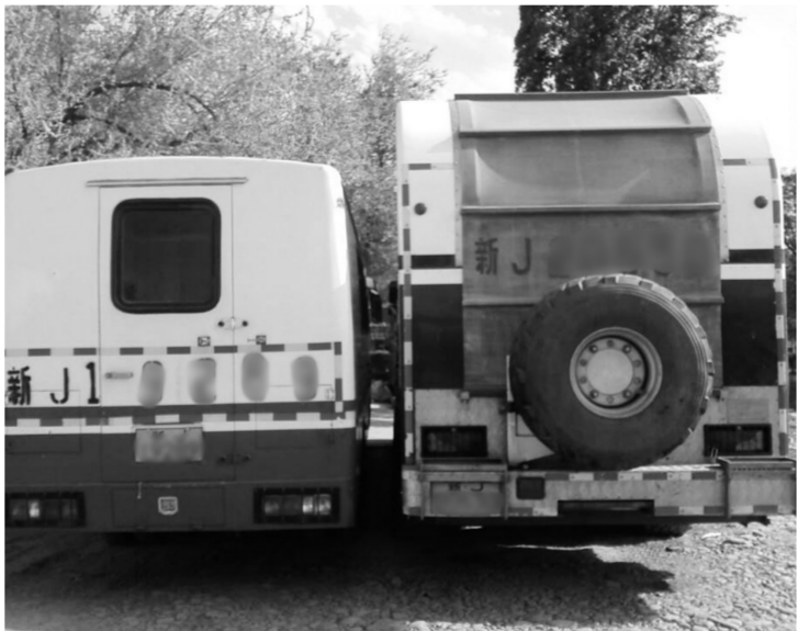
图为源车运源箱一个靠紧靠本队其他车辆,间隙小于20cm,严防人员靠近。两车间距较小,源箱无法被打开,保护了放射源的安全。王艳摄
