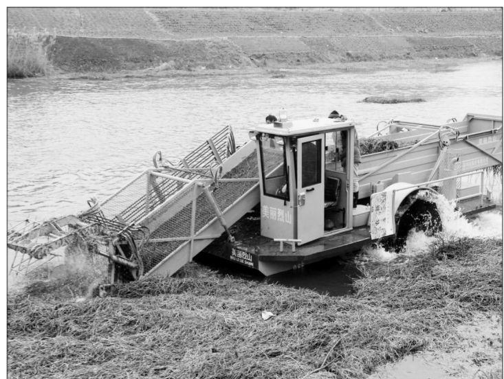
安徽省淮北市烈山区新型水面清洁船近日投入使用,每小时可清理5000平方米水面的各类水生植物,将对辖区内9条河道的冬季水生植物进行整治清理。 人民图片网供图/李鑫摄
