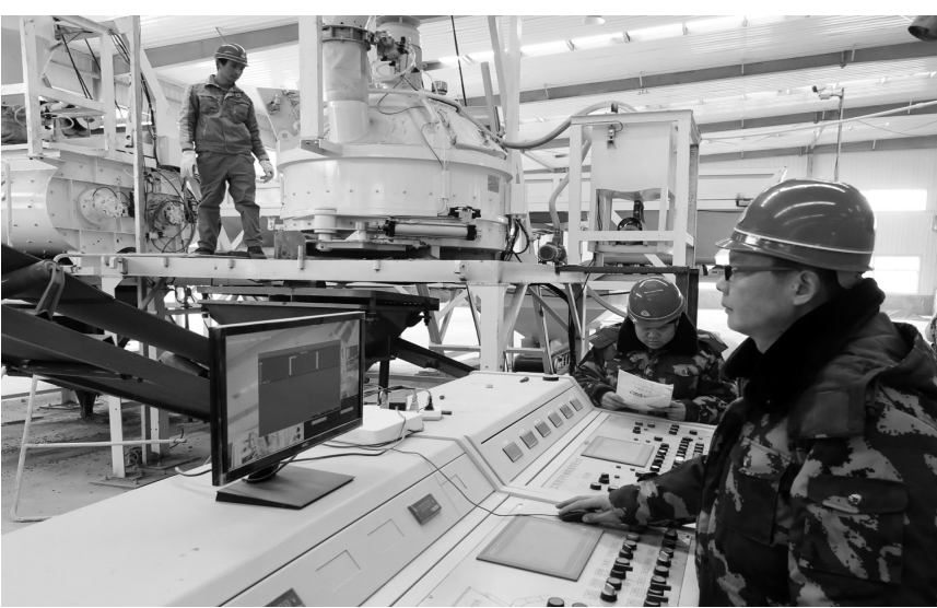
从垃圾中分拣出来的废砖瓦、砂石、玻璃片等材料与普通水泥混合再添加辅助材料等配制处理,可制成空心砖、多孔砖等,其产品与粘土砖相比,具有抗压强度高、抗压性能强、耐磨、保温、隔音效果好等优点。 本报记者邓佳摄
