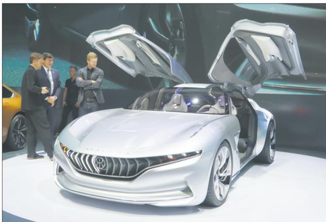
正道集团首发的超跑HKGT,采用了“清洁高效的发电机增程器和石墨超级电池黄金动力组合”技术,使车辆有更高的发电效率、更长的续航里程,以及更低的排放。
