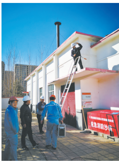
▲图为山东省德州市齐河县环境监测人员正在对企业锅炉进行采样。刘雪芹 高金鑫 董若义摄
