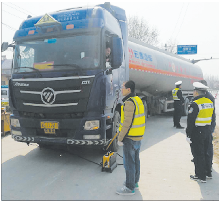
为加强柴油货车污染防治,打赢蓝天保卫战,山东省济南市加大监督抽测力度,在货车、渣土车集中通行的路段持续开展联合路检工作,重点检查柴油货车污染控制装置、车载诊断系统(OBD)、排放达标等情况,严厉打击超标排放等违法行为。图为济南市长清区环境监测站、机动车污染防治中心联合交警部门对重型柴油车开展路检。
