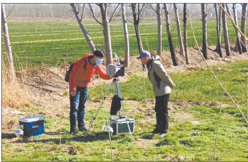
山东省济南市环境监测中心站日前对生活废弃物处理中心无组织废气和周边地下水进行专项监测,布设了5个无组织废气监测点位及5个地下水监测点位,严格按照规定进行相关指标监测。 公华林 王学鹏摄
