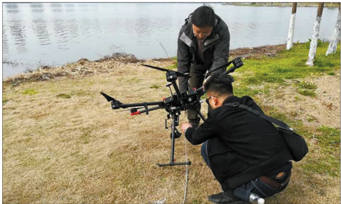
湖北省武汉市近日启动入湖排污口清查整治攻坚战,采集水样并进行现场测定和COD实验分析,同时通过船舶湖面巡查、卫星遥感监测等手段,对湖泊排口排污情况进行核实,实现对湖泊的立体调查,保证调查结果更精确。图为工作人员采用无人机采集水样并进行现场检测。 胡弘 李斌摄
