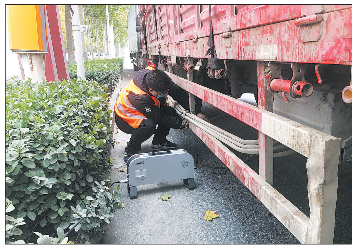
在保定市涿州地区进出市区交通干道上一个路检路查点,执法人员现场对过往柴油车尾气进行检测。 本报见习记者李茹玉摄
