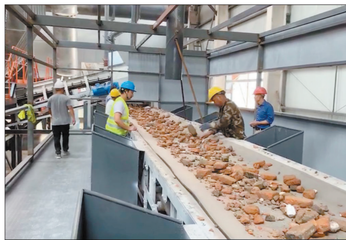
处置终端的工人们正对装修垃圾碎块进行再分拣。资料图片
