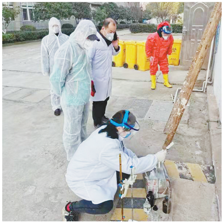
图为湖北省鄂州市环境监测站对医院医疗废水排口进行现场采样。
