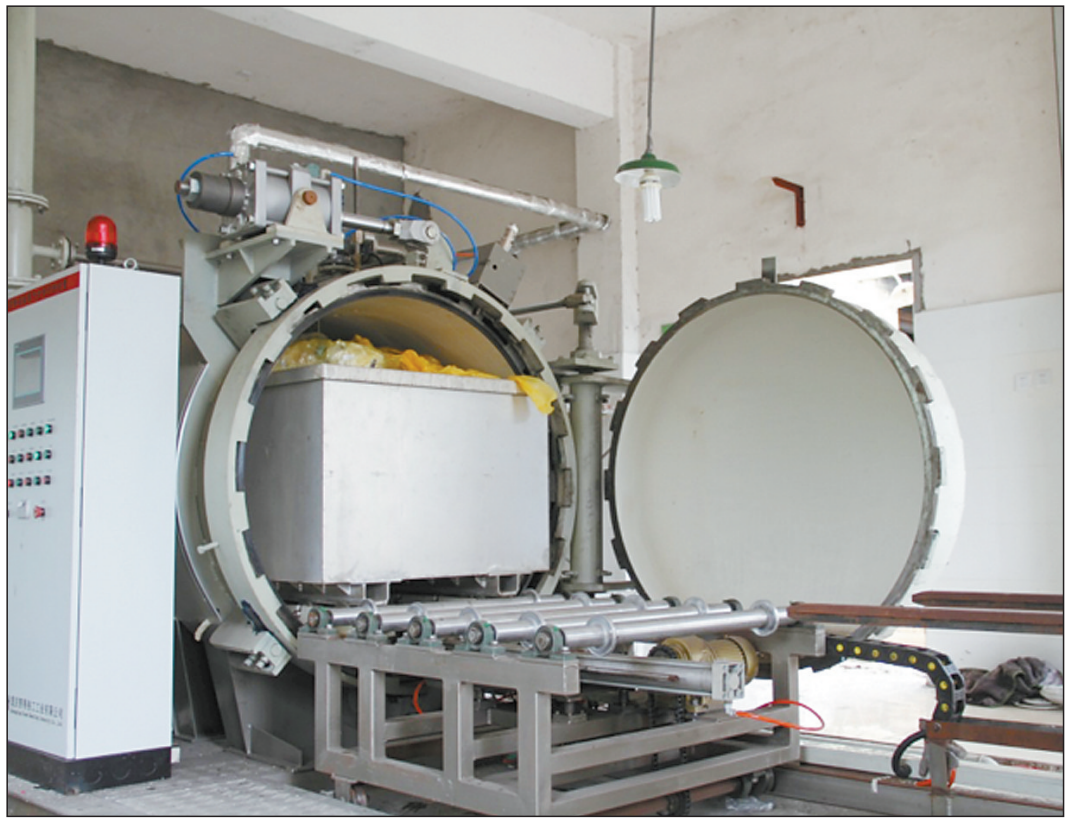
我国第一个医院医废就地化处置项目——四川省大英县人民医院投资110万元建设的日处理能力为1吨的处置项目。资料图片
