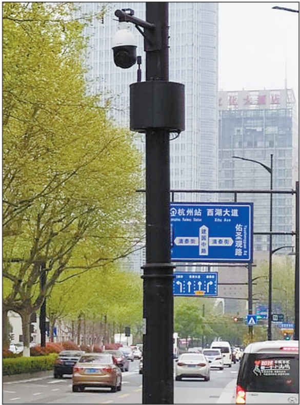
杭州市建国南路上的扬尘监测仪,像“螺丝帽”一样与灯杆融为一体。其监测范围可以小到0.001mg/m 3 的颗粒物。 本报记者钟兆盈摄
