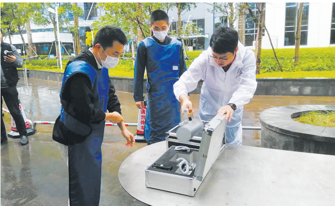
图为工作人员在演练现场开展现场γ辐射空气吸收剂量率及地表污染监测。海口市生态环境局供图
