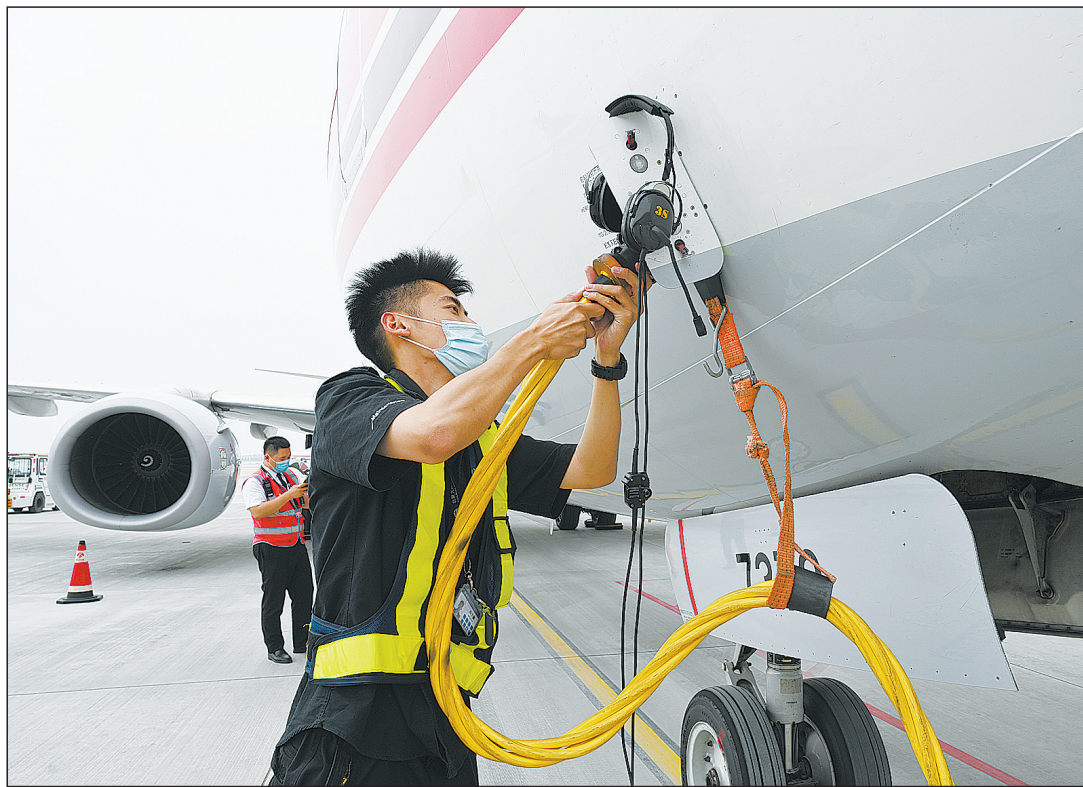
为减少飞机废气和碳排放,北京大兴国际机场加强大气污染防治,全面推广使用地面电源(GPU)、地面专用空调系统替代飞机辅助动力装置(APU)。专用空调系统能实现冷热源直接从航站楼接入,比常规系统大幅减少废气和碳排放,总能效提升50%以上。图为地勤人员为刚到港的飞机接入GPU系统。
