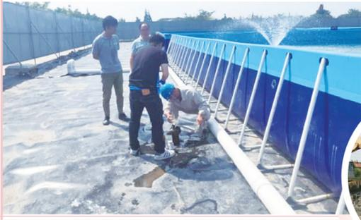
▲图为控制人员正在对处理后的渗滤液出水水质进行抽检。
