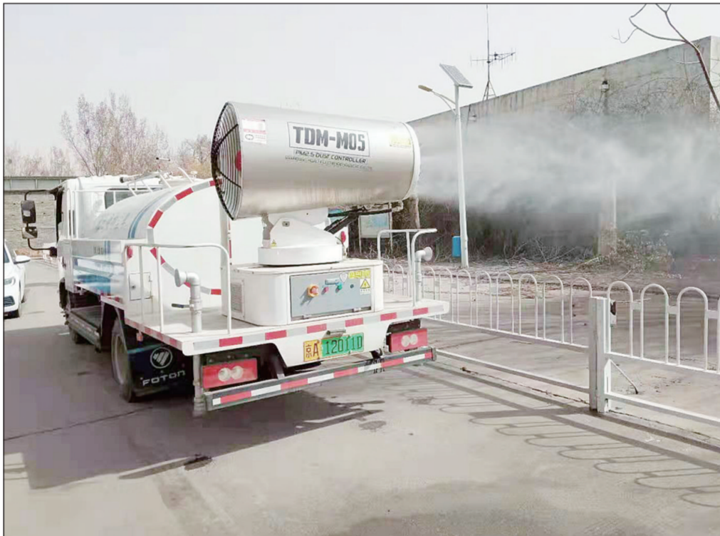
为全面应对沙尘污染天气,最大限度减轻沙尘和其他污染源对空气质量的影响,近日,北京市房山区生态环境局为各乡镇配备了100辆多功能抑尘车。据了解,抑尘车主要是通过喷雾气微粒吸附空气中的粉尘颗粒,从而起到固尘降尘的作用。 本报记者邓佳摄
