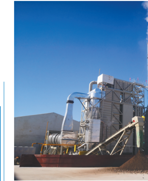
▲上图为采用直接热脱附技术对污染土壤进行治理的场景。
