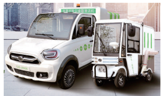
图为“晨曦”系列智能纯吸式除尘减霾清洁机(左为“晨曦I号”,右为“晨曦II号”)。
