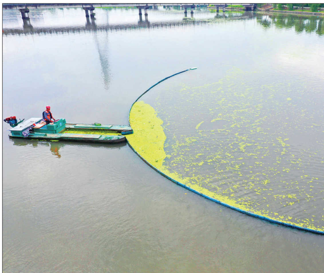
近年来,浙江省温岭市落实河长制主体责任,在河道常态化保洁中加强投入和监管。金清大港新河段保洁队新近引进新型漂浮物清理船,自动化程度高,一条清理船一个工人操作,在一般河道能代替15-20个人工,收集“围捕”漂浮物效果好,有效提升保洁效果,助推水质和生态环境改善。
