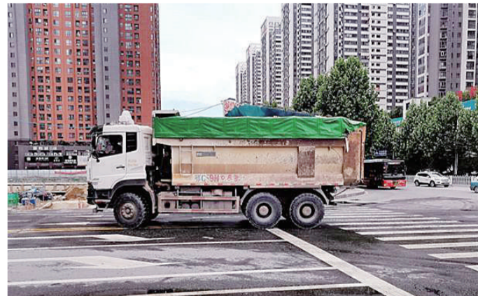
近日,湖北省十堰市在全市范围内开展扬尘污染防治攻坚战,通过源头管控,加大渣土外运监管力度。图为目前使用的全自动密闭新型智能环保渣土运输车,可减轻扬尘污染。 薛乐生 摄
