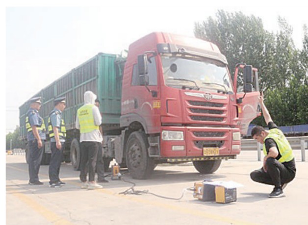
山东省济宁市生态环境局汶上县分局近日联合县交通运输局等部门,利用机动车排气污染遥感监测车、移动尾气检测设备以及道路黑烟车智能电子抓拍系统,进行尾气排放检测。 王漫雪 董若义 供图
