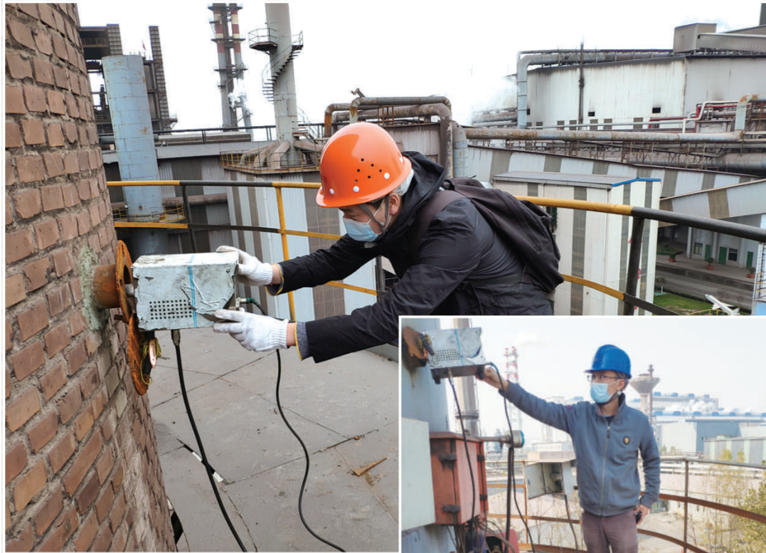
图为“一市一策”专家团队在邯郸市的钢铁企业采集VOCs排放数据。 程龙摄
