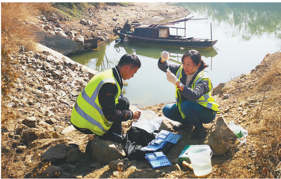
▲图为生态环境部指派贵州省生态环境厅的工作人员,在赣州市赣县区湘江镇开展长江入河排污口(赣江段)异地交叉排查。工作人员运用快速检测包检测排污口外排水水质情况,对排污口类型进行初步判定。江西省生态环境厅执法局供图
