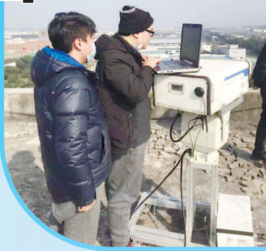
图为成都生态环境部门运用大气气溶胶激光雷达进行监测。
