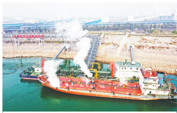
12月13日,湖北省宜昌市化学品船舶洗舱站开始进行洗舱作业。这一洗舱站位于枝江市姚家港水域,采用污水全自动化处理工艺,有毒气体检测、除臭和新风系统及无人值守巡检系统等工业智能4.0标准建设,可清洗包括苯类、醇类、酸类、碱类等多门类危化品,可同时满足两艘5000吨级船舶洗舱作业,洗舱能力达600艘次/年,每年可接收处置化学品洗舱水及污染物15万吨,是长江流域智能化程度最高、功能最齐全的化学品船舶洗舱站。 人民图片网供图
