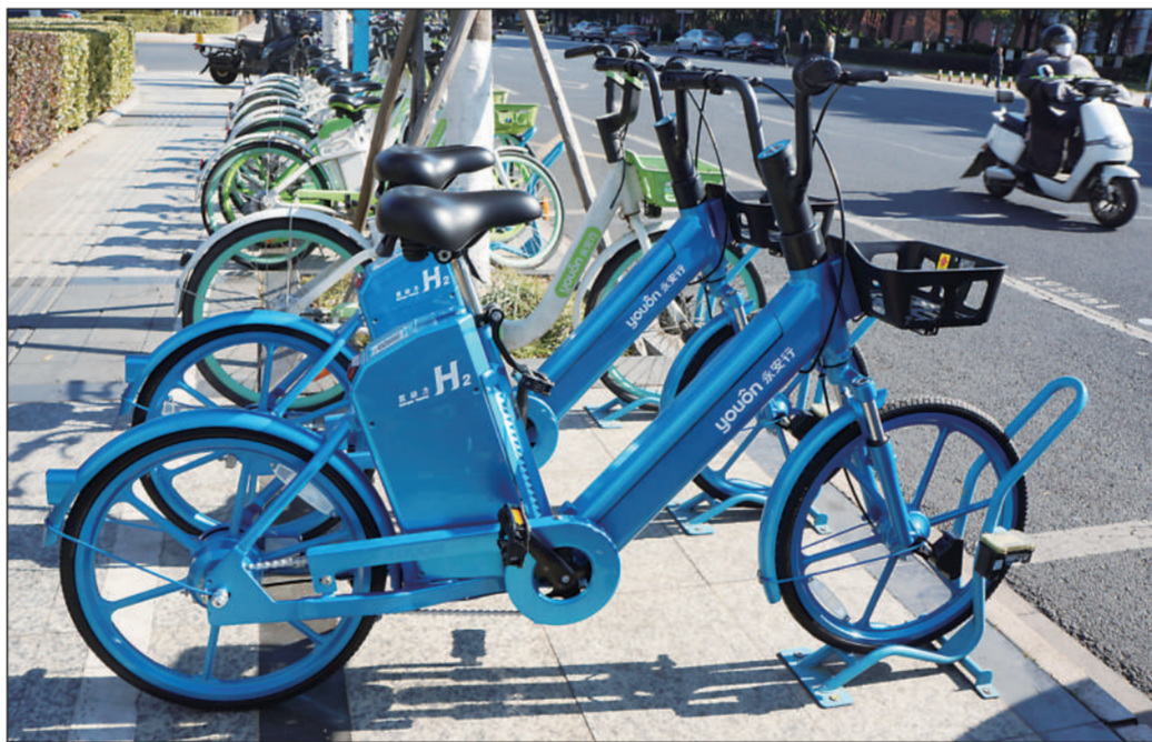
首批1000辆氢动力新能源共享自行车近日在江苏省常州市主城区地铁、公交站点和医院、商超等人流量密集场所周边投放运营。这批氢动力共享自行车采用氢能新材料和工艺,在车身安装了氢气发电机和储氢器,储氢0.5立方米,便可续航70公里。 人民图片网供图
