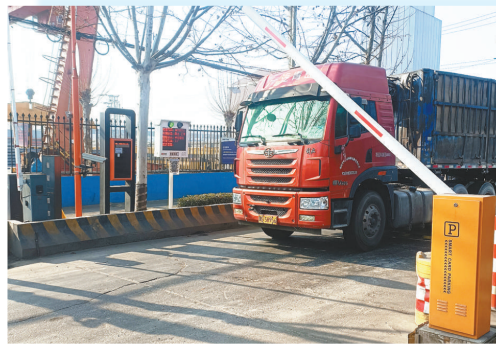
图为重点用车单位门禁系统可自动识别超标车辆。
