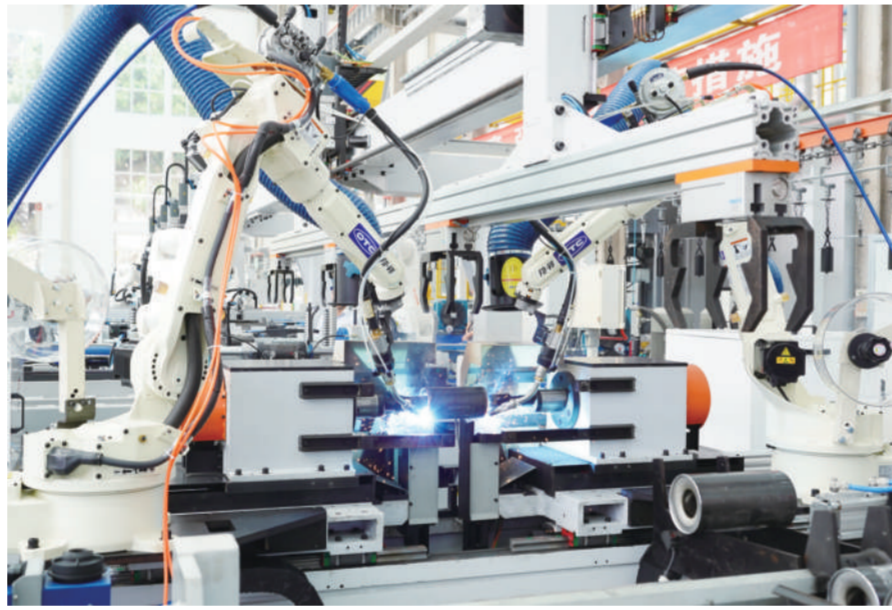
图为龙净环保智能化托辊生产线,可实现托辊生产、加工、装配、喷涂、检验及包装等一体化的工艺流程,满足多种规格、多种结构的托辊制造。 资料图片
